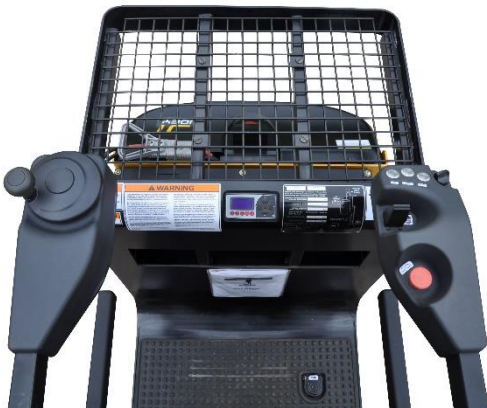
Big Joe: Left Hand Mini Steering Wheel Right Hand Fingertip Travel Control
